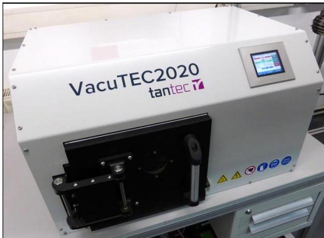
Die VacuTEC-2020 Niederdruckplasma-Anlage dient zur Vorbehandlung von leitenden und nicht leitenden Materialien. Der größte Vorteil ist, dass das Plasma alle Flächen der zu aktivierenden Bauteile umgibt und somit auch überall gleichmäßig vorbehandelt und dass die Prozesstemperatur gemäßigt ist.
